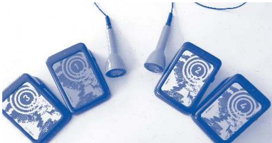
Les **faisceaux sonores** permettent que les personnes à mobilité très réduite puissent jouer en toute autonomie puisqu'ils sont d'une grande sensibilité aux mouvements. Les faisceaux mesurent avec précision la distance, la vitesse des gestes réalisés pour les transformer en note.
